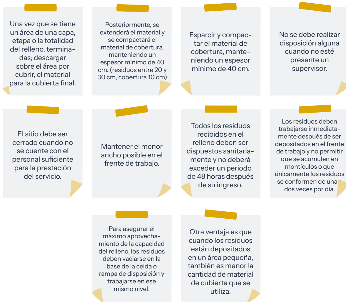
Figura 61. Beneficios de la cubierta intermedia de residuos.
